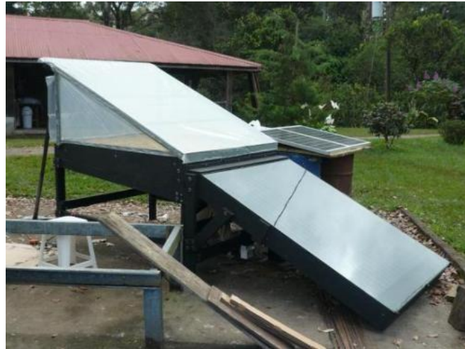
Secador Solar en funcionamiento
