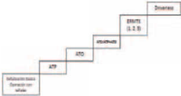
Figura 3. Escalera de automatización de los modos de conducción.
