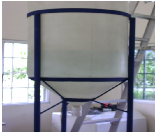
Fig. A1.3. Tanque con agua para probar el muestreador.
