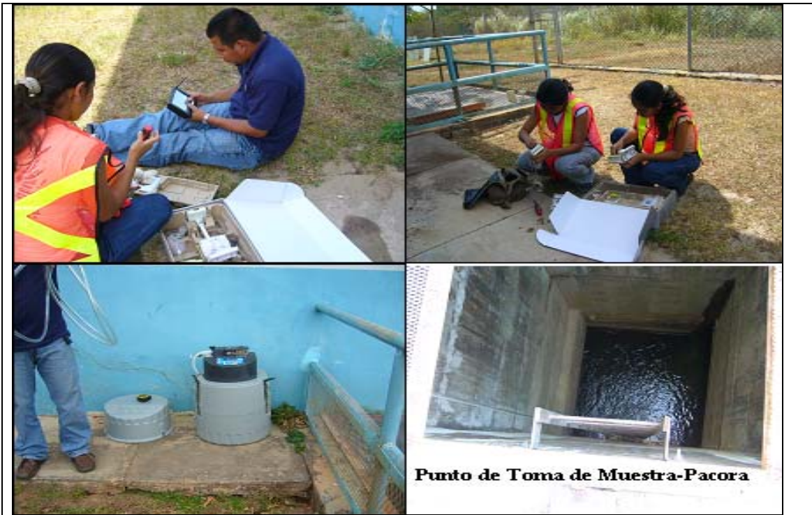
Fig. 4. Estudiantes de Tesis y Personal del CIHH realizando la instalación del Equipo en la Toma de Agua de Pacora
