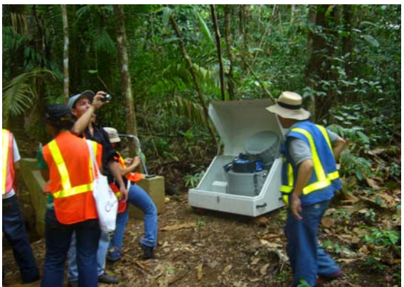
Participantes del seminario aprecian la instalación del Muestreador ISCO 6712 en Cerro Pelado- Gamboa.
